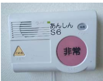
緊急通報装置
